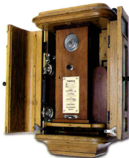
En af Aktieselskabet Kjøbenhavns Telefon-Automaters mønttelefoner, model 1898 i en senere udgave uden håndsving.
