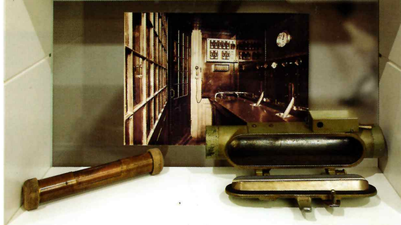
Fra Berlins kejserlige rørpostsystem, 1877. Byen fik igennem årene et gigantisk rørpostsystem, der dækkede over 300 kilometer. Alene i året 1898 passerede over 2,3 millioner forsendelser gennem rørene. Museum für Kommunikation, Berlin.
