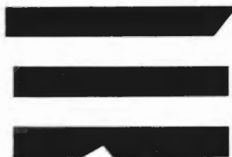
Bjælkefejl A. Hak i undersiden af nederste bjælke
